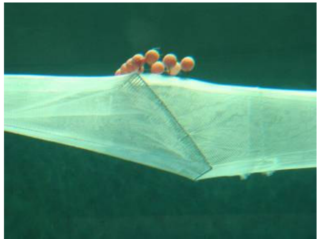
Mynd 1. Líkan af meðaflaskilju í tilraunatanki Hirtshals Danmörku. Auðvelt að taka mælingar á opnun á skiljuhólki miðað við mismunandi toghraða.
