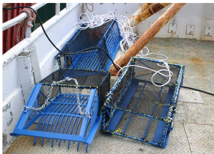
Mynd 5. Plógur 1 með útskiptanlegan afturhluta um borð í Adda á Gjábakka.
