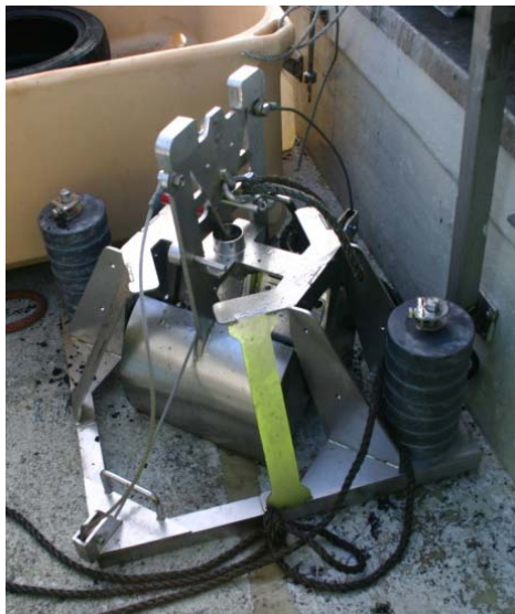
Mynd 8. DayGrab sem notuð var við sýnatöku haustið 2008. Greipin hentar vel þar sem botngerðin er mjög þétt og erfitt er að komast niður í setið. Hægt er að þyngja greipina um allt að 70 kg. Til að komast niður í setið. Myndin er tekin um borð í Frú Magnhildi.
